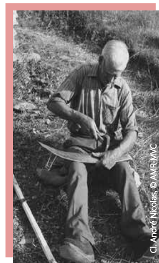
Monsieur Bonicel en train de battre sa faux, d'amincir le métal au niveau du tranchant de la lame avec un marteau spécifique et une petite enclume fichée en terre, La Tabatière, Chamborigaud (30).
