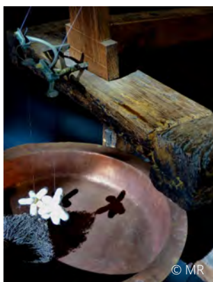
Détail d'un tour traditionnel familial et d'une bassine en cuivre permettant de dévider les cocons et de former le fil de soie.
